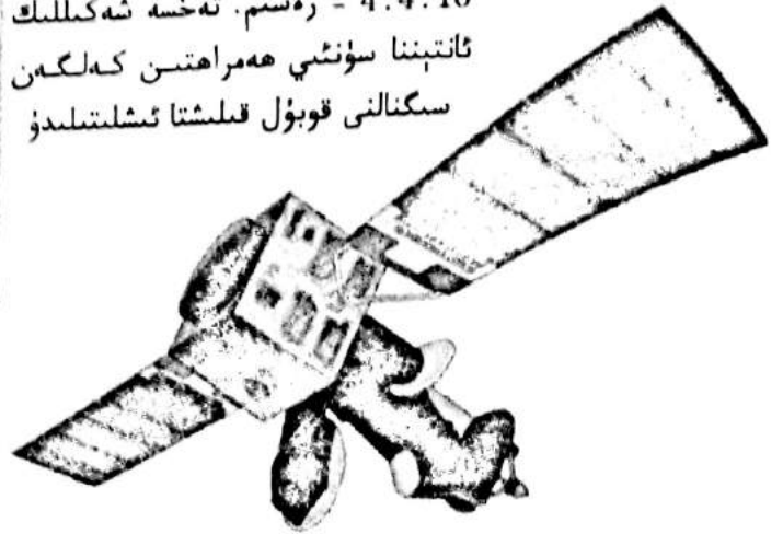
3.4.10 - رەسىم. ئالاقىلىشىش سۈنئىي ھەمراھى. تاختا شەكىللىك ئىككى قاننى بولسا قۇياش باتارېيىسى تاختىسى بولۇپ، ئۇ قۇياش ئېنېرگىيەسىنى ئېلېكتر ئېنېرگىيىسىگە ئايلاندۇرۇپ، سۈنئىي ھەمراھنى تەمىنلەيدۇ
